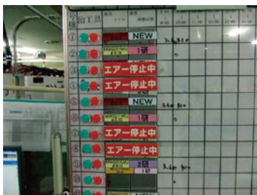
設備エア停止中の看板表示
