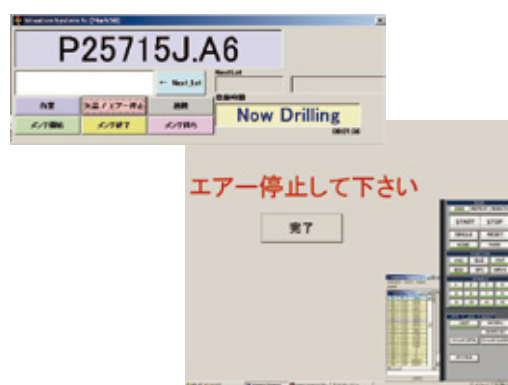
非稼働時の設備モニターにエア停止指示を表示
