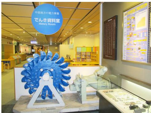
「写真：千草発電所の旧水車ランナーとノズル」
